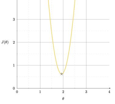
$$heta^* = ig([\, 2\ 3\ 4\,] egin{bmatrix} 2 \ 3 \ 4 \end{bmatrix}ig)^{-1} \ \ [\, 2\ 3\ 4\,] egin{bmatrix} 5 \ 6 \ 7 \end{bmatrix} = rac{X^ op Y}{X^ op X} = rac{56}{29} pprox 1.93$$
